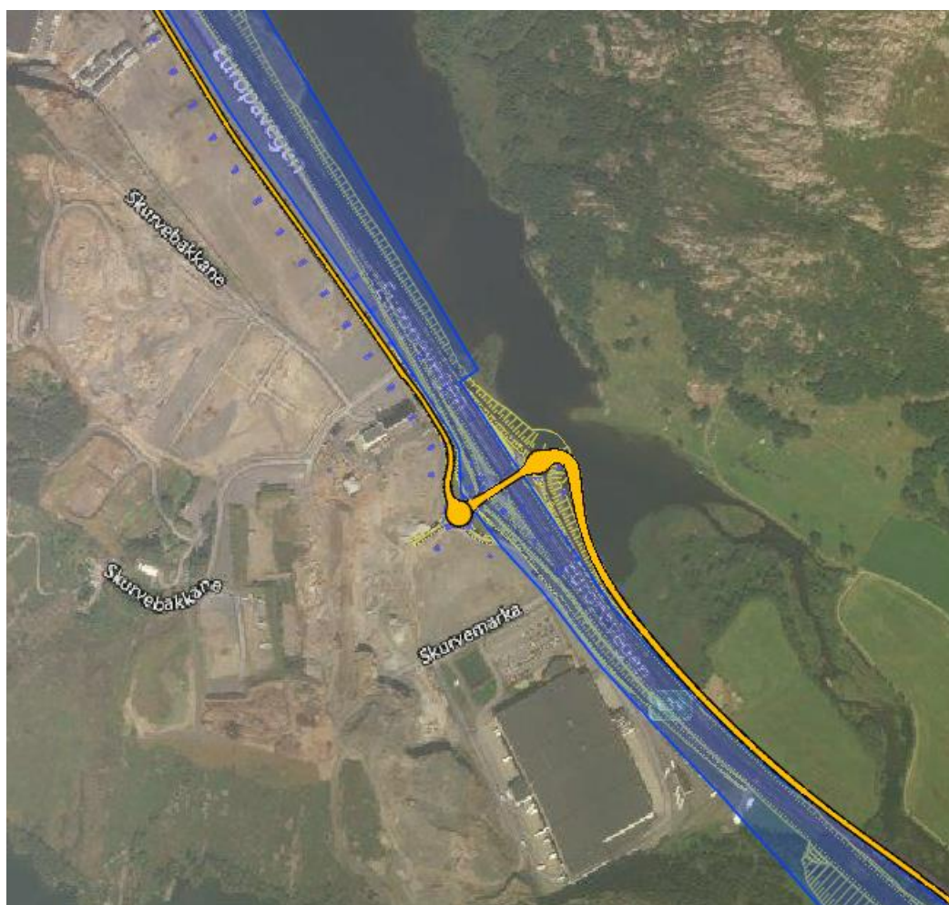
Figur 4-20: Skurve fase 2 - Gjennomgående trafikk på ny lokalveg, gjennom kryss og via Skurveverka. Etablere ny E39 og resten av kryssområde
