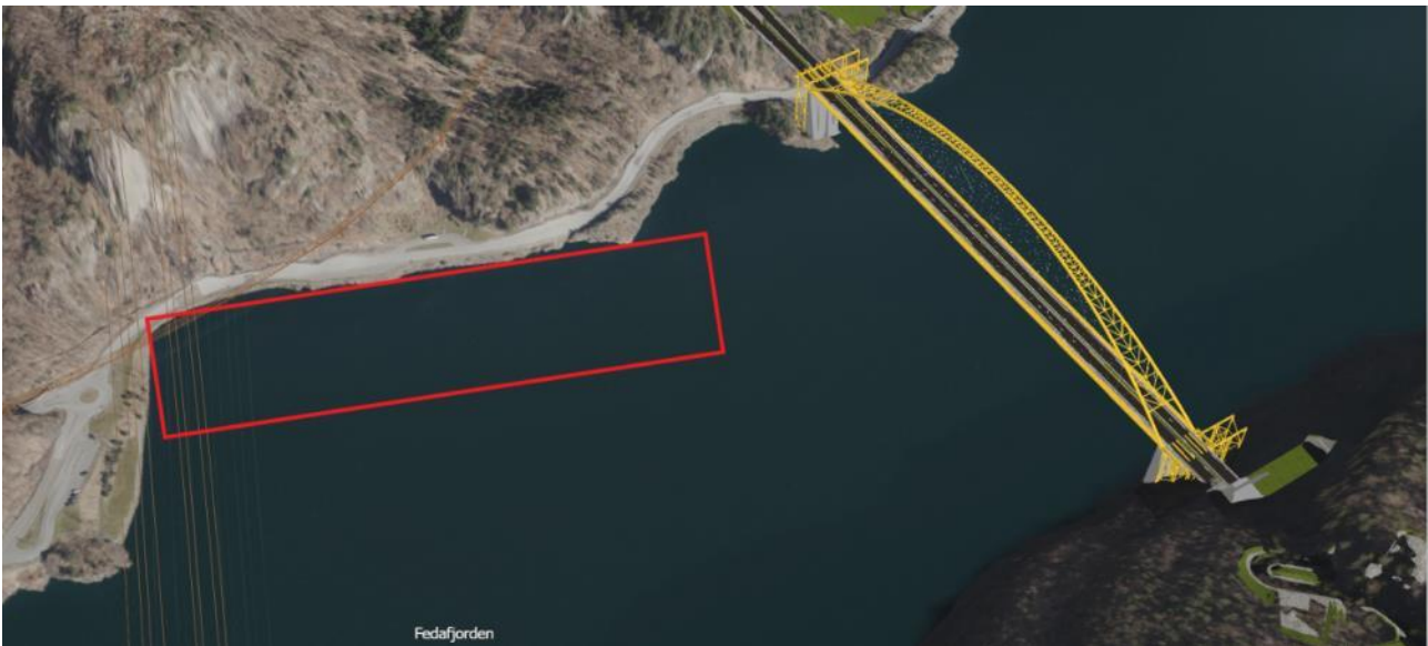
Figur 7-31: Område til oppankring av lektere for sammensetting av nettverksbuebru
