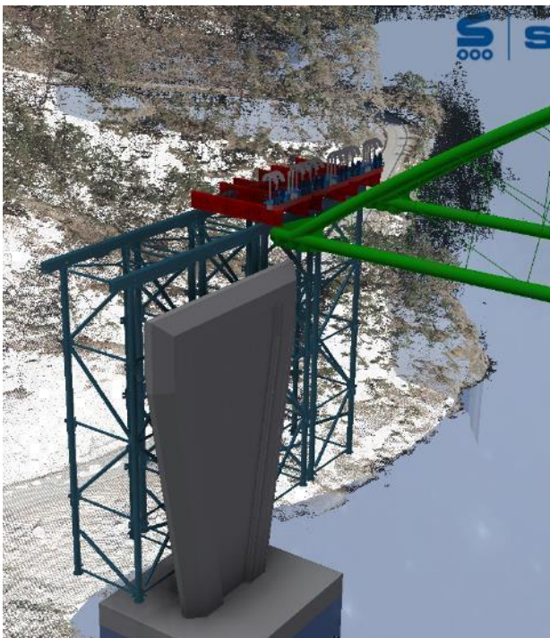
Figur 7-33: Foreløpig forslag til system for heising og montering av nettverksbuebru. Kilde: Sarens
