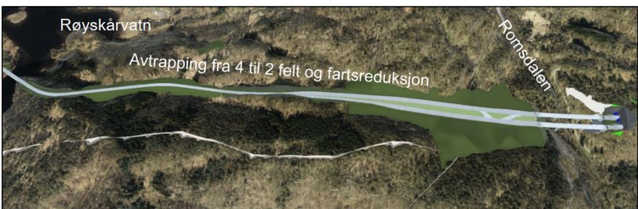
Figur 7-9: Midlertidig overgang fra fire til to felt inn på eksisterende E39 på Røyskår
