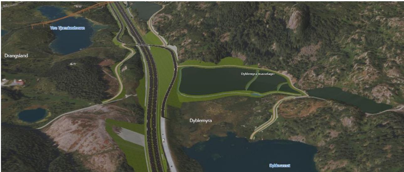
Figur 7-18: Omlagte lokalveier ved Tjomsland, bru over E39 og område for masselager ved Dyblemyra
