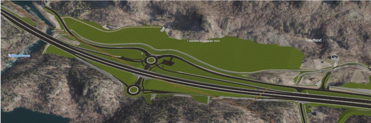
Figur 7-39: Nytt toplanskryss på Frøytland. Hevet og utvidet landbruksareal, omlagte bekker og Høylandsveien i kulvert under ny E39
