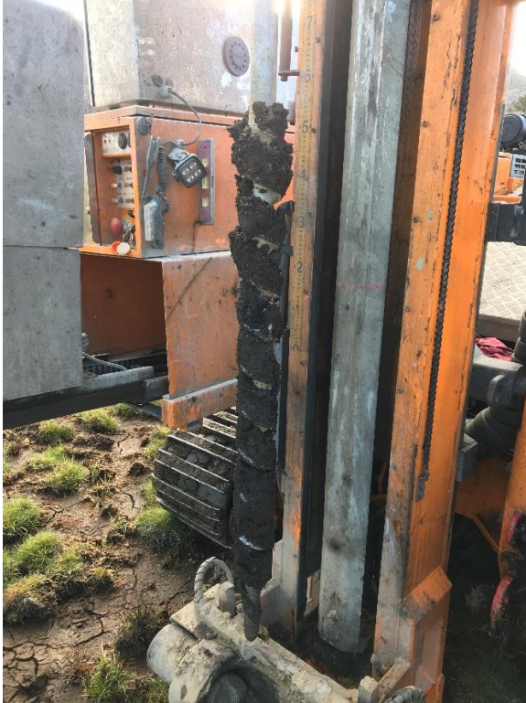
Figur 4: Løsmassene fra toppjord i punkt E46.
