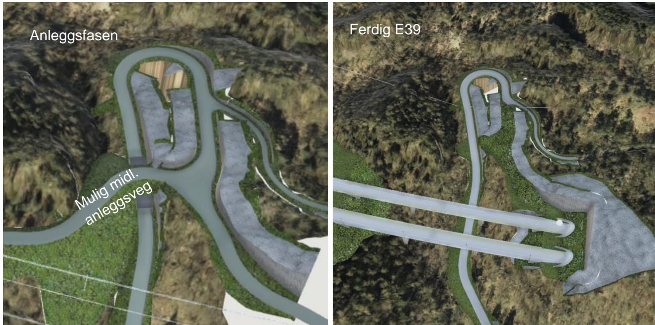
Figur 20: Figur til venstre viser planlagt anleggsveg med midlertidig fylling tvers over bekk i Romsdalen. Anleggsveien skal fjernes når tunnelarbeid er ferdig (t.h.).
