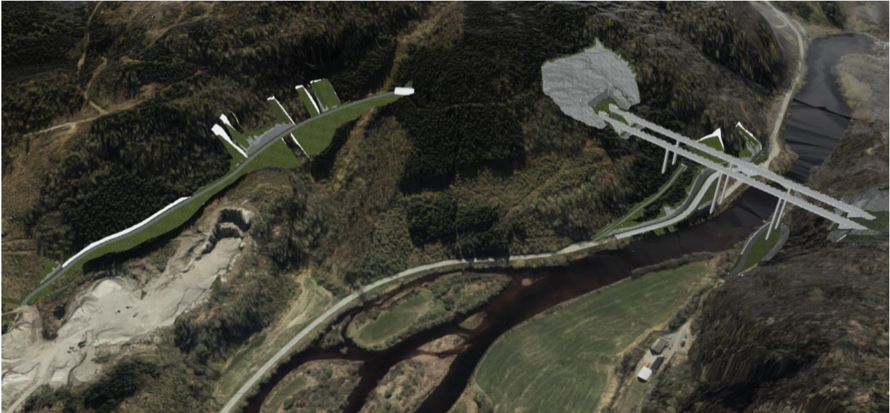
Figur 7: Midlertidig anleggsveg må etableres for tilkomst til østre tunnelportal. Terrenget settes i stand etter endt anleggstid, men bergskjæringene som kreves for å etablere veien vil utgjøre permanente terrenginngrep. Modellutsnittet viser midlertidige anlegg i byggefasen, og her sees også den midlertidige omleggingen av fylkevegen under Kvelland bru.
