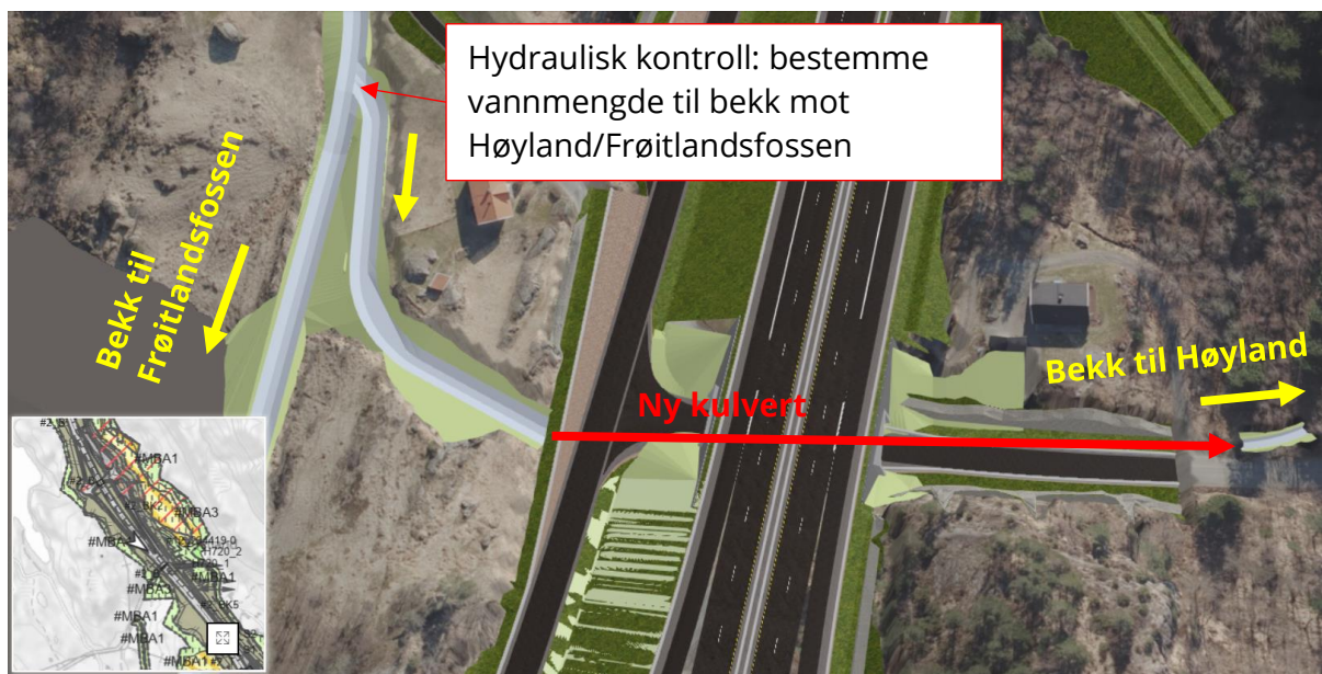
Figur 4-7: Omlegging av bekk til Høyland på Frøyland for strekning med veiprofil ca. 17150-12700. Utklipp fra 3D-innsynsløsning med synsvinkel mot sørøst.
