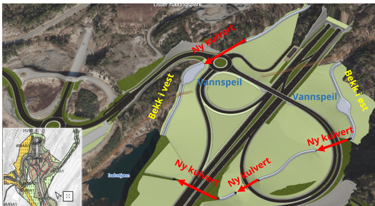
Figur 4-4: Omlegging av bekker ved Indretjønn (øst og vest) ved veiprofil ca. 12000. Utklipp fra 3D-innsynsløsning med synsvinkel mot nordvest.
