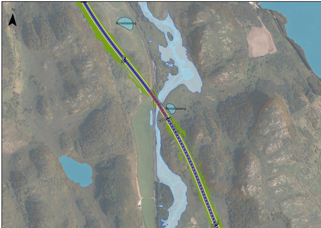
Figur 4-19: Oppsalåna Bro – med flomsone etter utbygging.
