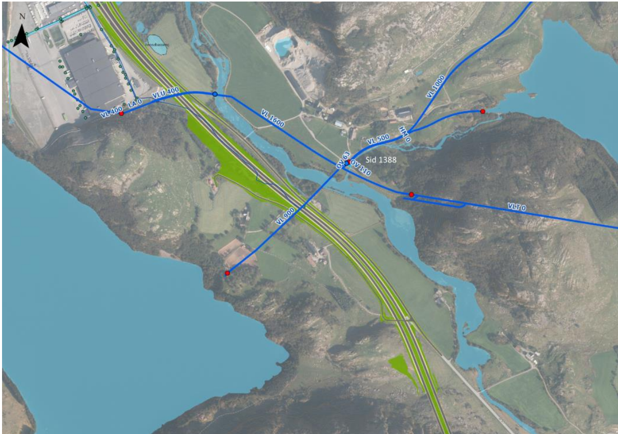
Figur 3-3: IVAR råvannsledninger ved Skurve. SID 1388 er mulig sted for å hente slokkevann til tunnel.
