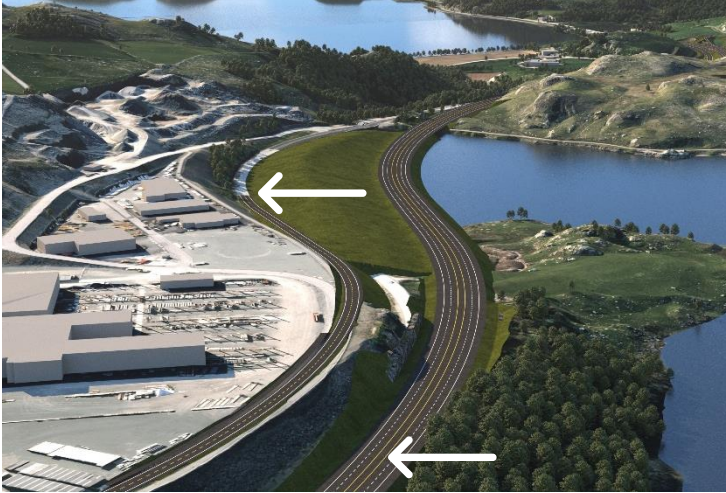
Figur 6-28: Utklipp fra visningsmodell viser nord for Skurve. Nederst i bildet ligger ny E39 over dagens. Utklippet viser også hvor dagens E39 kobles på vei opp mot næringsområdet. Veien foreslås regulert med større bredde.
