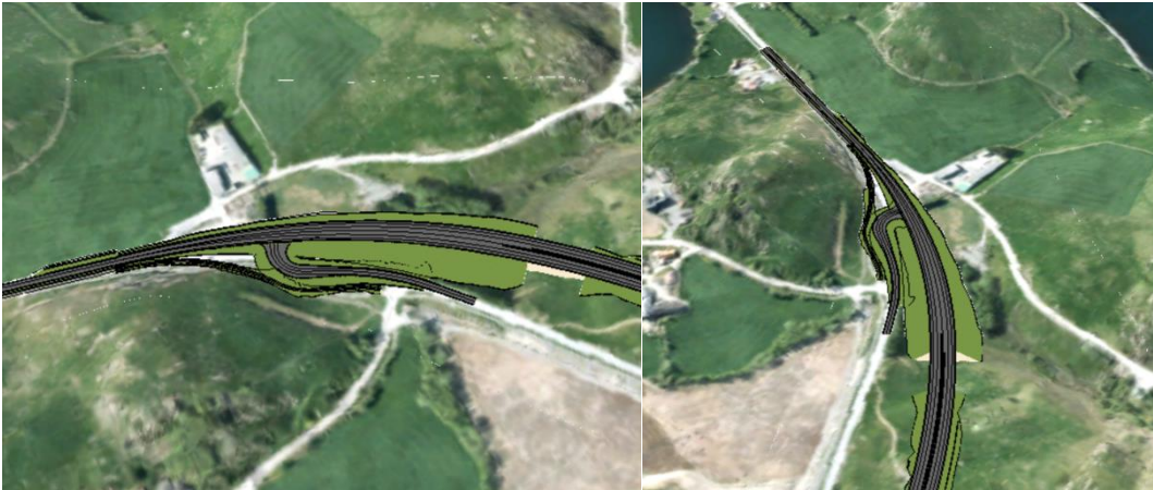
Figur 6-32: Midlertidig prosjektavslutning med T-kryss på Bollestad, sett fra vest og sør
