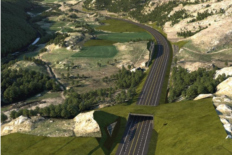
Figur 6-7: Modellbilde som viser faunapassasje/viltkulvert i Søylandsdalen, sør i delstrekning B.
