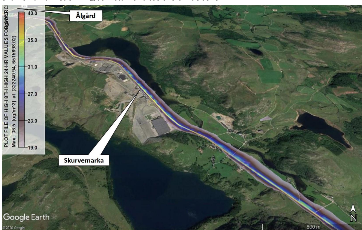
Figur 4-1: Utbredelse av gul og rød sone omkring den nordligste delen av traseen i form av 8. høyeste døgnmidlet PM_{10} -konsentrasjon ( \mu g/m^3 ) for 0-alternativet (2050). Spredningskartet er presentert i Google Earth.
