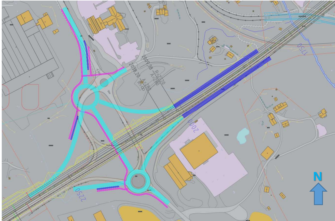
Figur 11: Alternativ - "Ny overgangsbru - ruterkruss"
