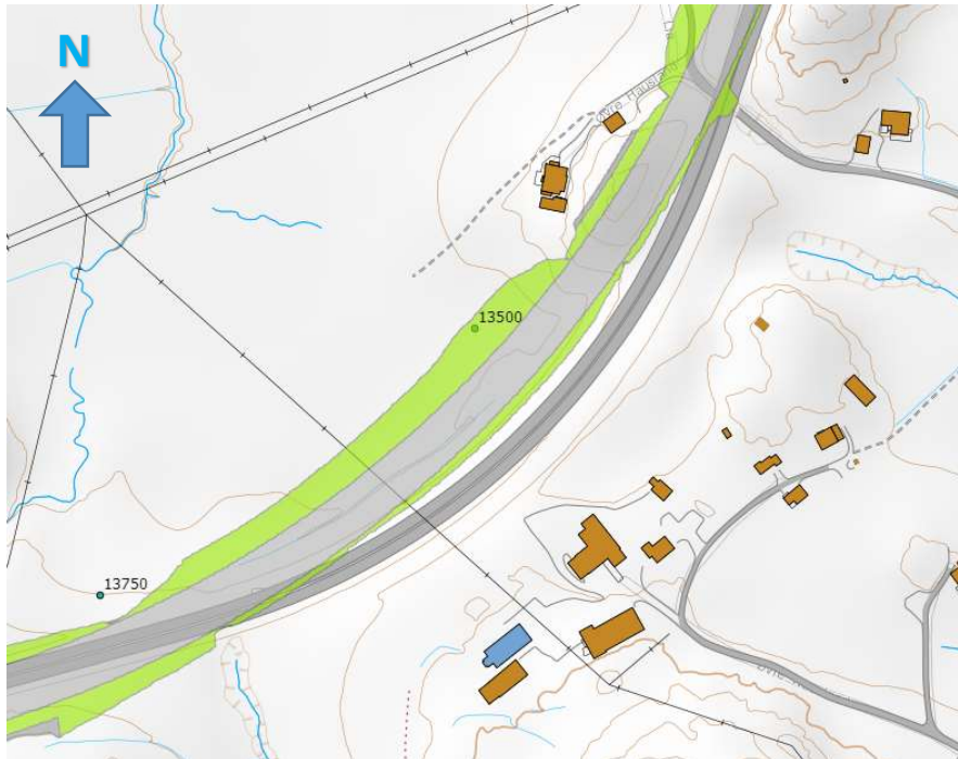
Figur 16: Eksisterende veg har for knapp kurvatur før Grimstadporten, Rh 387, pr 13500
