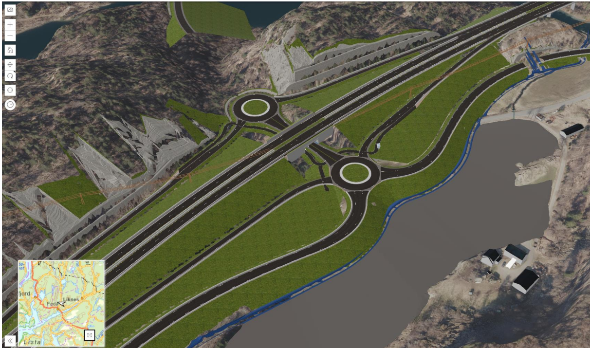
Figur 11: Utklipp fra 3D-innsynsløsning som viser veimodell med Frøytland kulvert og rundkjøringer. Masselager på myrområdet er vist med grått. Synsvinkel mot vest.
