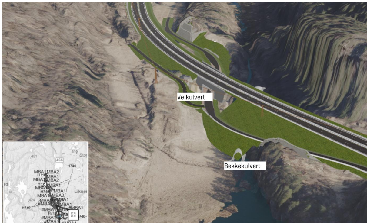
Figur 16: Utklipp fra 3D-innsynsløning som viser hovedveilinje og lokalvei samt kulvert ved Store Meland. Synsvinkel mot nordøst.
