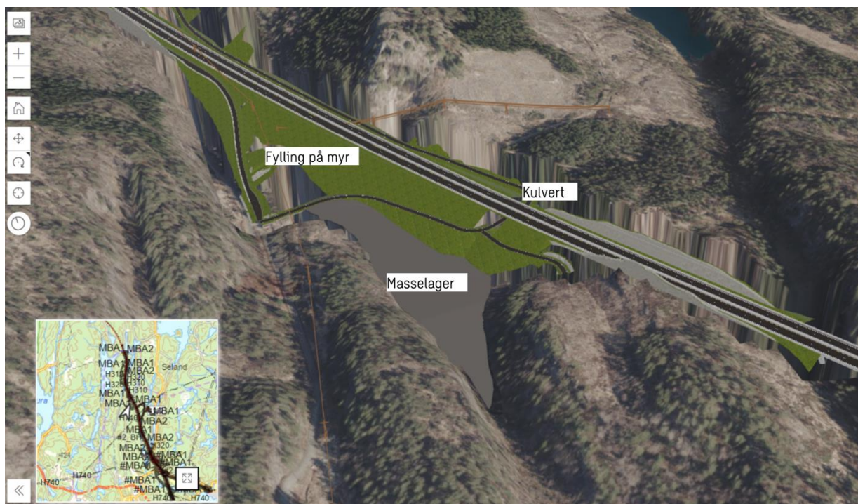
Figur 15: Utklipp fra 3D-innsynsløning som viser veifylling, kulvert og masselager ved Melandsveien/Bjønnåsen. Synsvinkel mot nordøst.
