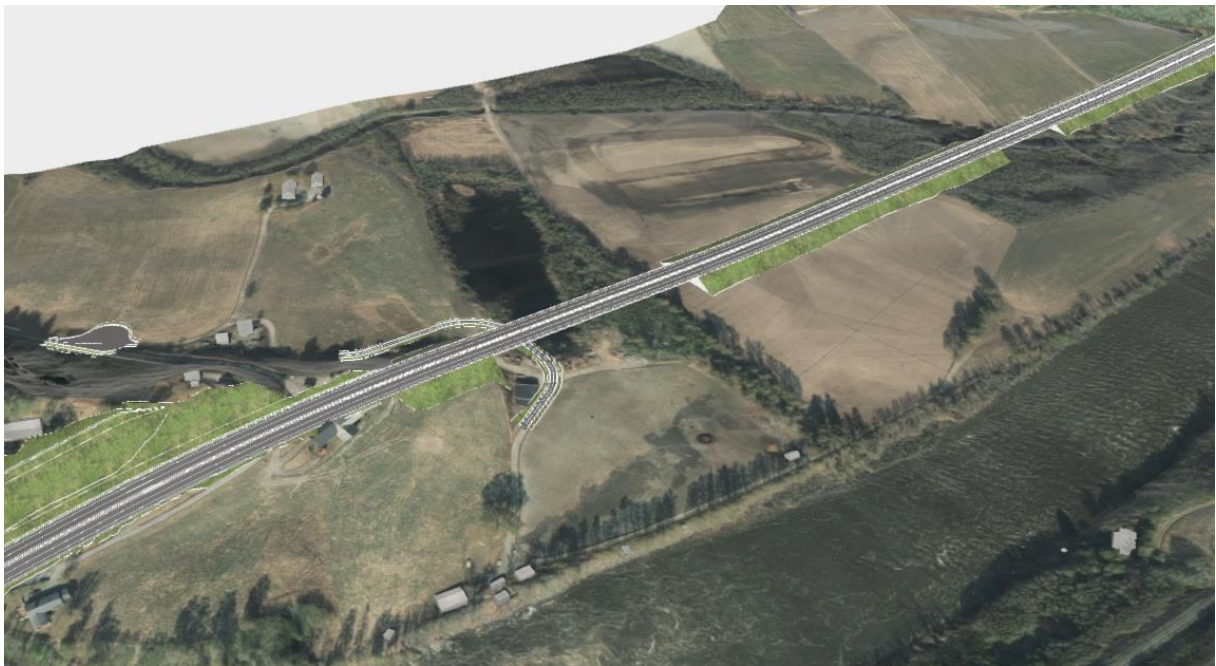
Figur 12: Alternativ 1.2C (100 km/t) – fylling og bru nord for Hovinåsen
