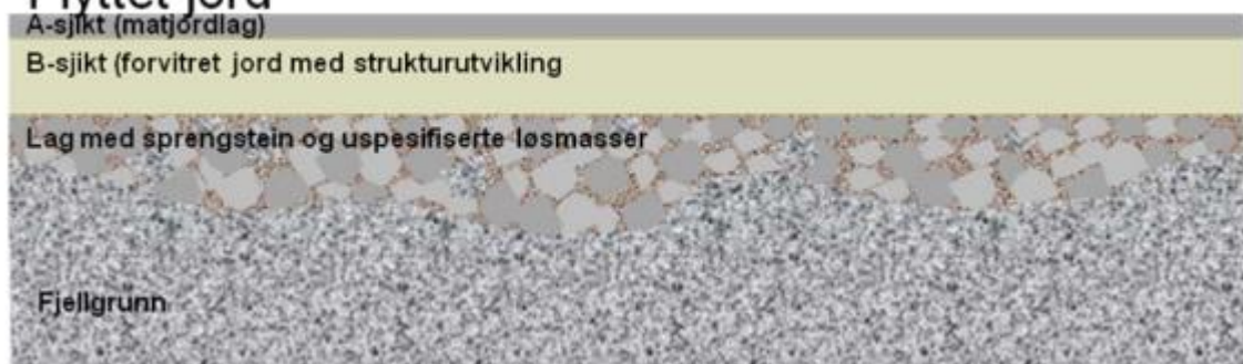
Figur 6-1 Prinsippskisse for oppbygning av naturlig lagret jord og flyttet jord (Bioforsk, 2012)
