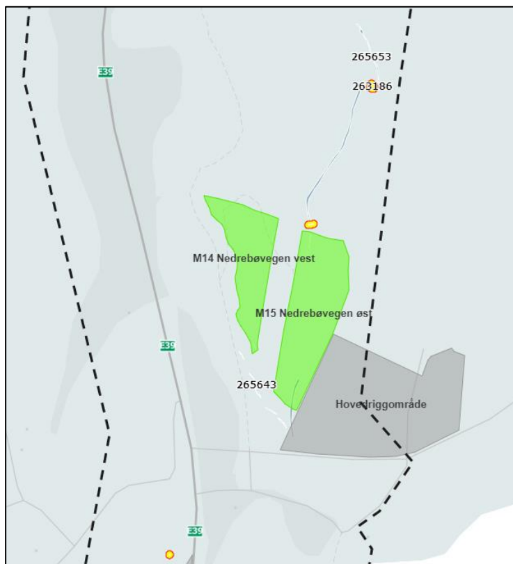
Figur 6-22 Kart fra innsynsløsning 11032021, med masseuttak ved masseunderskudd (i grønt), og riggområde (i grått) som ligger innenfor delområde 5.
