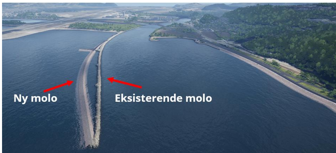
Figur 13: Illustrasjon av planforslag, med gammel molo. På det meste justeres ny molo omtrent 40 meter nordover (Illustrasjon av Rambøll).
