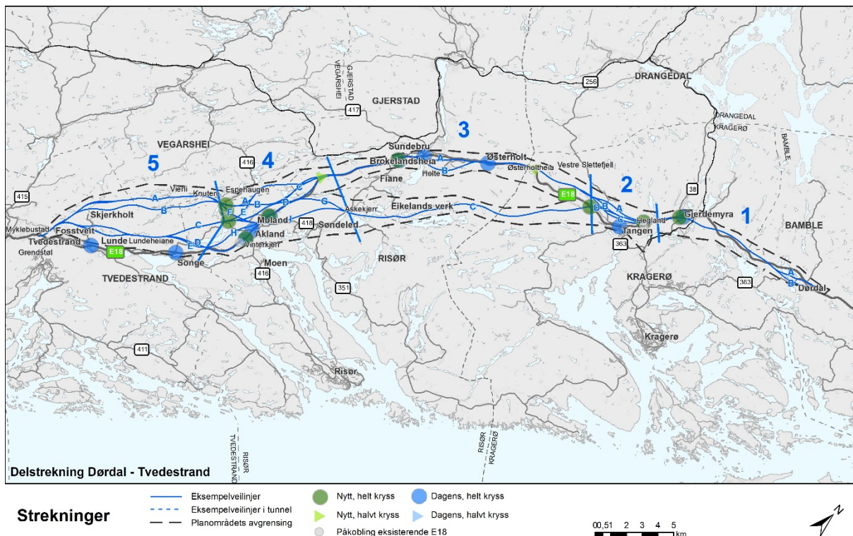
Figur 7. kart over delstrekning Dørdal - Tvedestrand med inndeling i strekninger og eksempellinjer. Delstrekning Dørdal – Tvedestrand er delt inn i 5 kortere strekninger. Eksempellinjene innenfor hver strekning betegnes med en bokstav A til I avhengig av antall eksempellinjer innenfor hver strekning. Vestre eksempellinje innenfor hver strekning er alltid betegnet med A.
