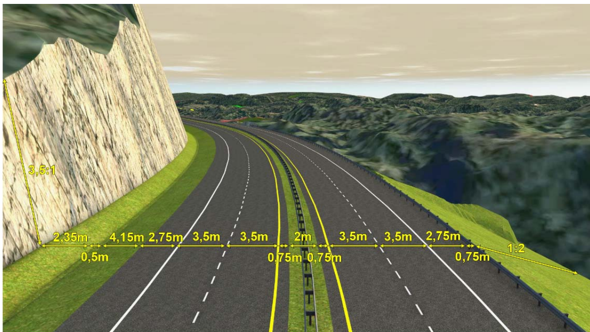
Figur 2 Tverrprofil veiklasse H3nv
