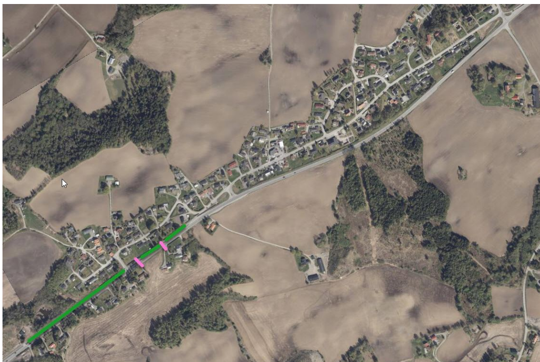
Figur 3.1-10 Gangkryssinger på delstrekning 2 ved Vangli. Grønnfargen markerer strekning med rekkverk, rosa streker viser hvor det er åpninger i rekkverket.
