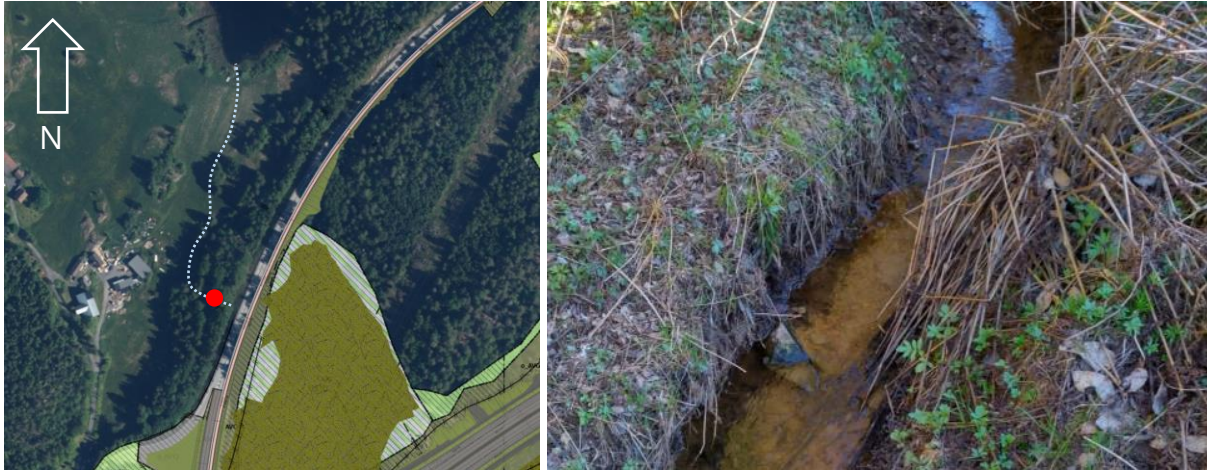
Figur 6-9: Bekk ved Gjerde (antydnet med blå stiplet strek) renner ut fra fyllingen under dagens E18 som er et vandringshinder (rødt punkt) og over landbruksjord i nordlig retning ut til Gjerdevannet. Foto viser kanalisering (NIBIO)
