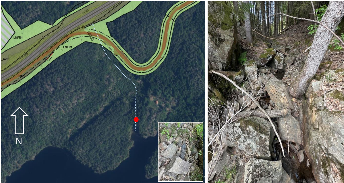
Figur 6-17: Liten bekk som renner ut i Hullvann ved Mostrand. Rødt punkt og høyre bilde viser vandringshinder (grov blokk). Minibilde viser at bekken strekningsvis går i rør under landbruksveien (Sweco Norge)
