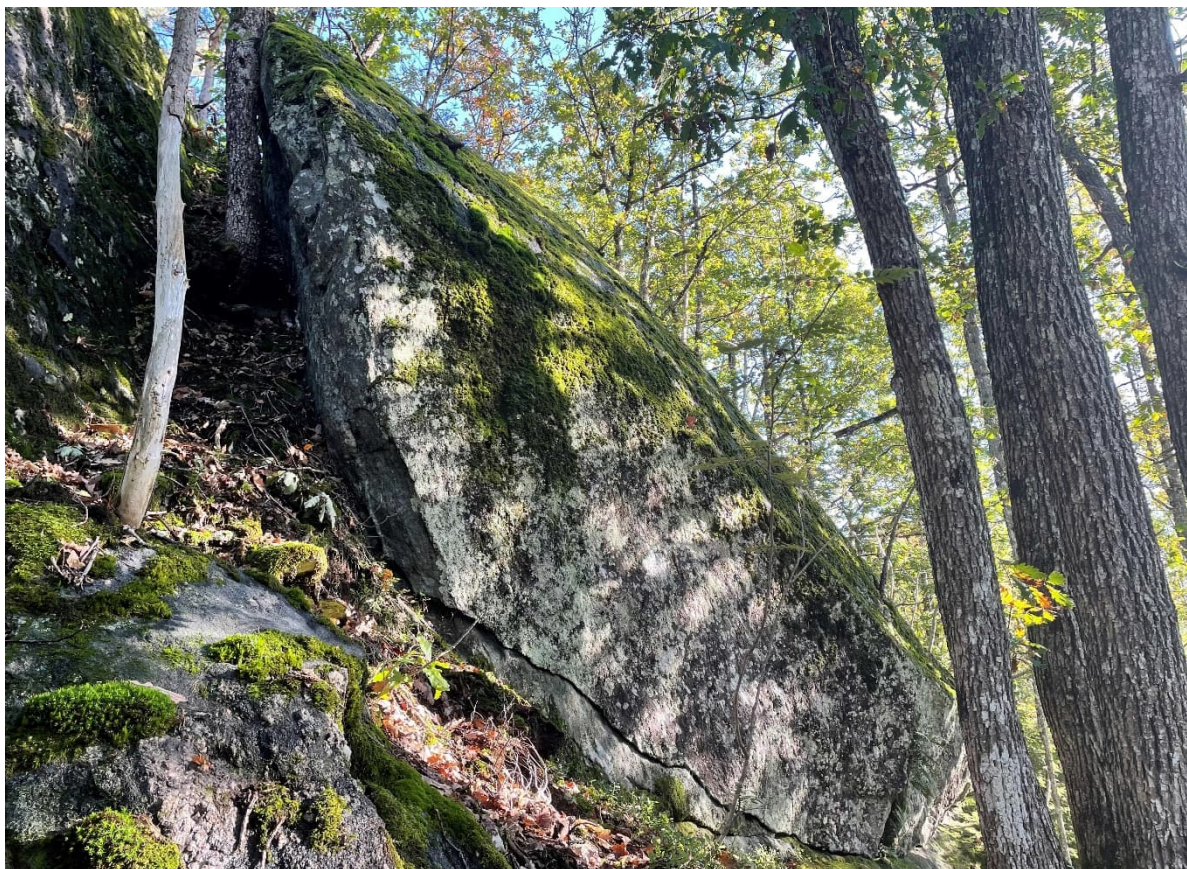
Figur 11-5: Avløst blokk rett i overkant av planlagt bergskjæring på venstre side av hovedveien ved profil 12280-12300. Sett mot øst. Fotograf Ingvild Sangesland Qvist.
