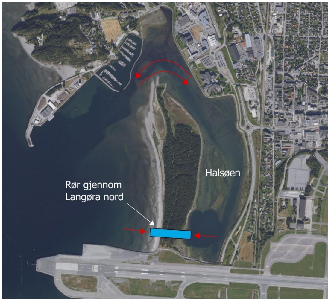
Figur 5: Illustrasjon av tenkt åpning gjennom Langøra sør for å forbedre vannkvaliteten i Halsøen. Merk at figuren ikke viser nøyaktig plassering eller gjennomføring.
