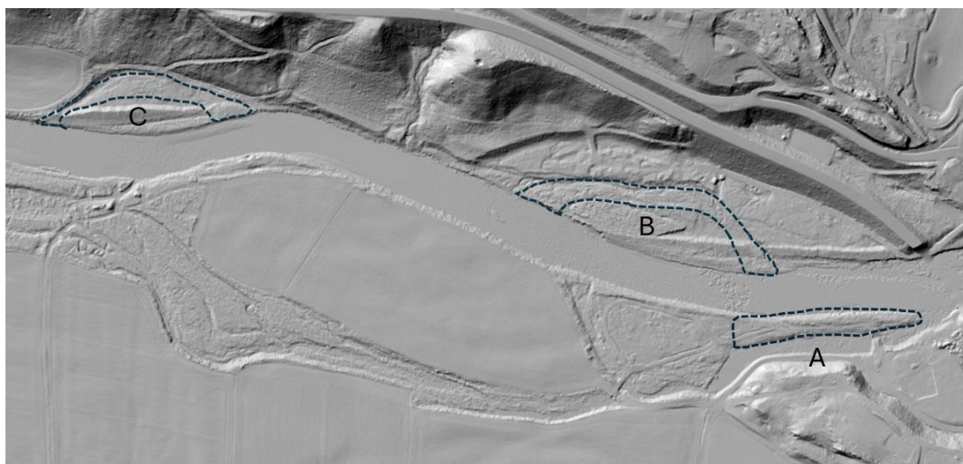
Figur 6-4. Område A: Denne resten av oppgravde elvemasser kan med fordel fjernes. Dette utvider elvetverrsnittet i området og sørger for bedre tilkobling av nyåpnet løp for Veslegausa. Område B og C: Disse flomløpene er delvis avskåret og henger sannsynligvis noe i terrenget da Gausa har gravd seg dypt i området. Åpning av inn- og utløp samt senkning av flomløpet vil kunne gi nye viktige funksjonsområder for fisk og ferskvannsorganismer.
