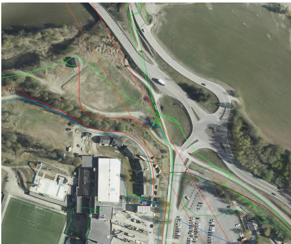
Figur 6-18. Eksisterende kabler og ledninger.
