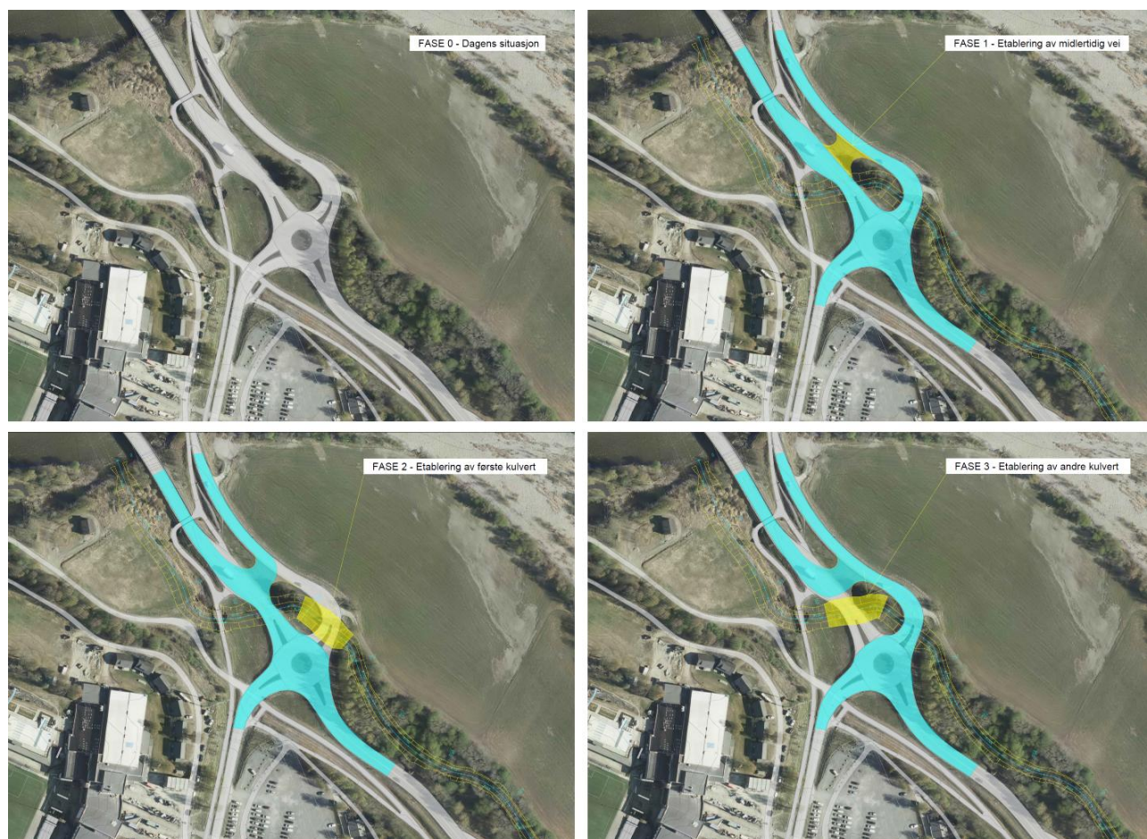
Figur 6-16. Mulig faseinndeling for etablering av kulvertkonstruksjoner
