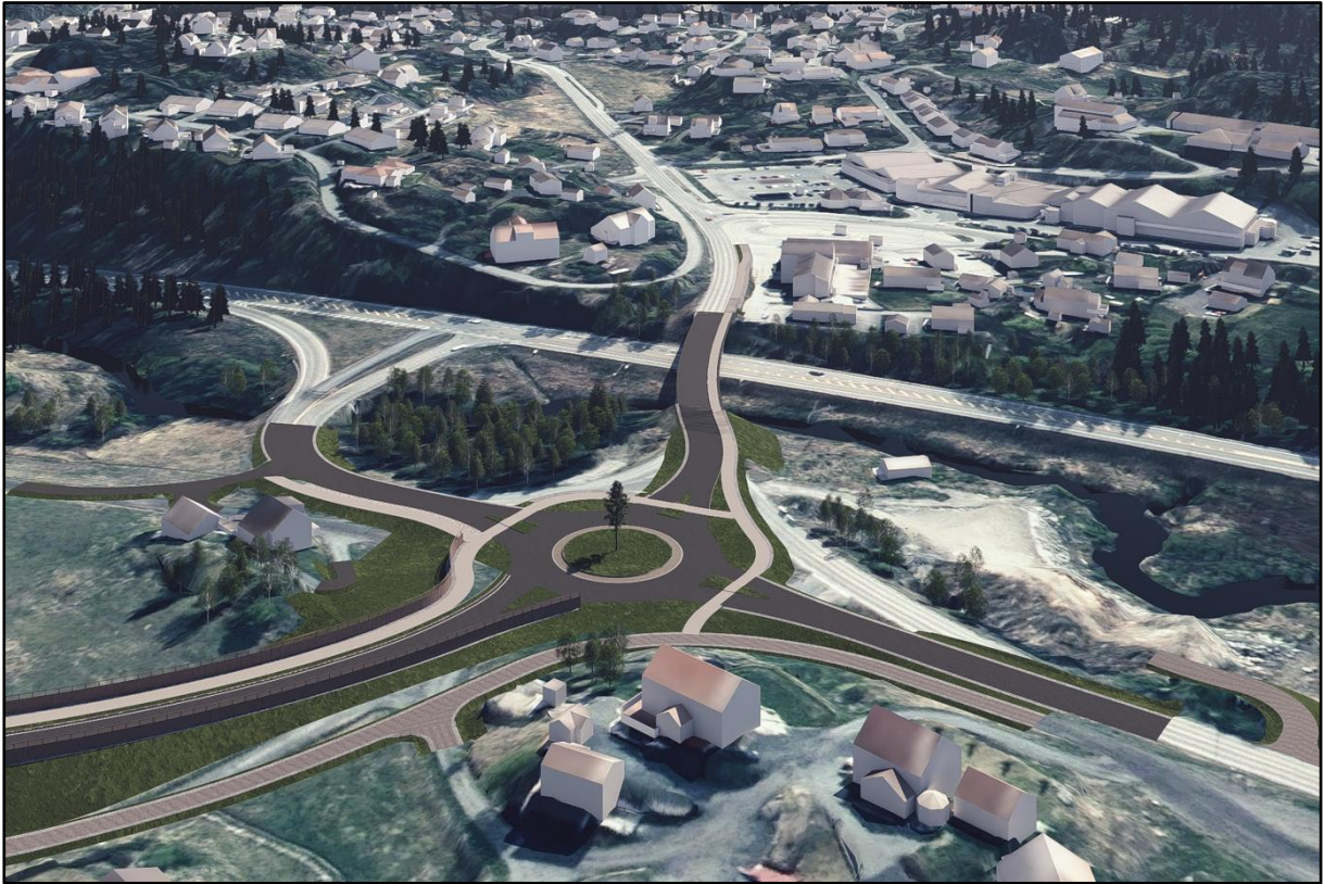
Figur 3-16: Rundkjøring som kobler ny sidevei mellom Sannidal og Fikkjebakke, sett fra nordvest. (Kilde: Sweco)
