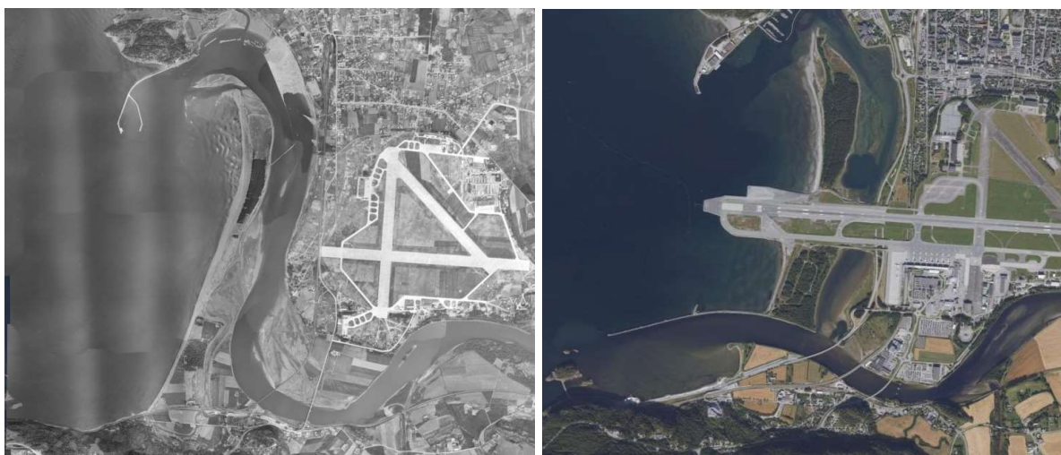
Figur 8-2: Øverst til venstre: Stjørdalselva før utvidelse av flyplassen i 1955. Øverst til høyre: Stjørdalselva med nytt utløpsområde ved Hellstranda i 2022 (Statens vegvesen, NIBIO og Statens kartverk, 2024).
