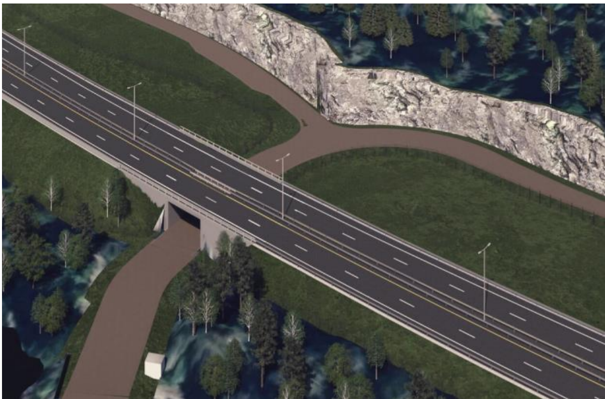
Figur 4-19 Rørholtveien under E18 i ny kulvert. (Kilde: Sweco)
