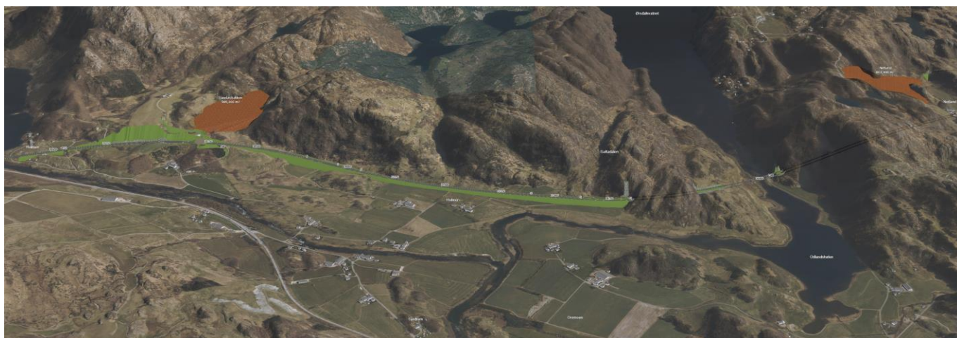
Figur 7-9: Rød linje i KDP-korridoren på strekningen Odlandshølen-Holmen-Svelavatnet. Forslag til masselager med brun farge
