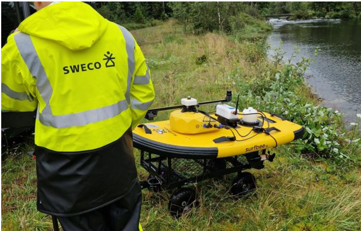
Figur 4-19: Måling av vanddybder. Sweco
