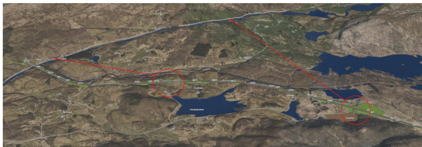
Figur 6-28: Prinsipp for vei fra E39-kryss ved Årrestad til Sirdalsveien og fra E39-kryss ved Haugatjørn til Sirdalsveien
