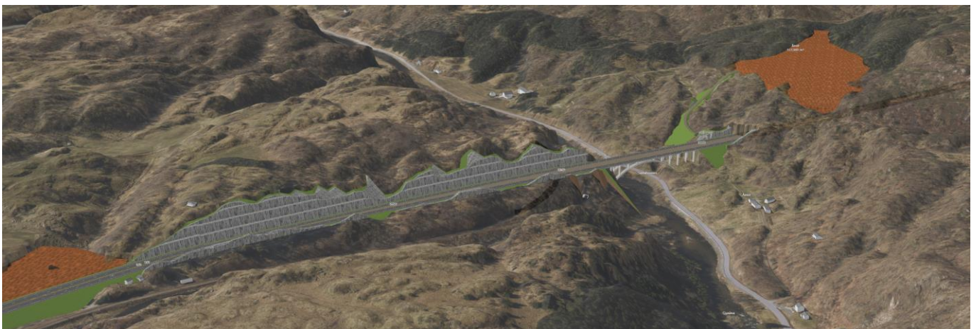
Figur 6-6: Utsnitt fra modell av blå linje, Årrestad-Gyaåna-Åmot. Forslag til masselager i brun farge
