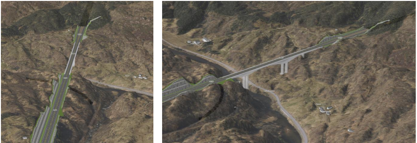
Figur 6-51: Oransje linje, med én bro som lander høyere i terrenget til en kort dagsone ved Åmot. Bro-type er ikke bestemt, figuren viser bare et eksempel
