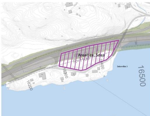
Figur 6-1: Område avsatt for knusing av masser ved Bakkevann.
