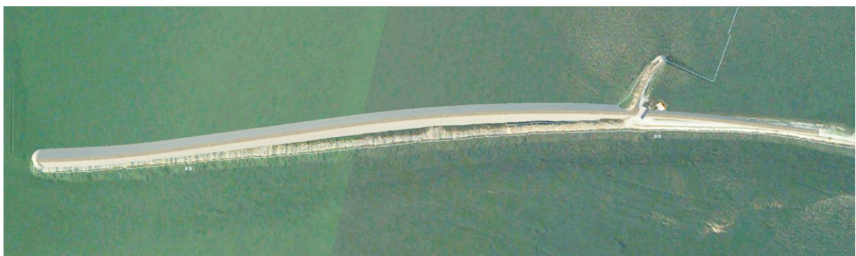
Figur 10: Justering av molo. På det meste omtrent 11 meter nordover.
