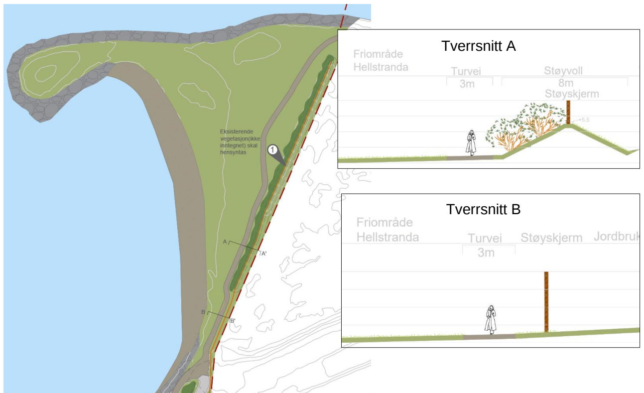
Figur 9: Illustrasjon av støyvoll/skjerm prinsipp langs Hellstranda friområde, både i snitt A og B.
