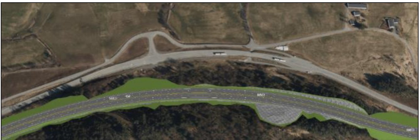
Eksempel på sving med ny geometri og eksisterende vei
